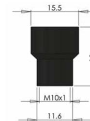
25D se termine par un embout fileté M10x1
